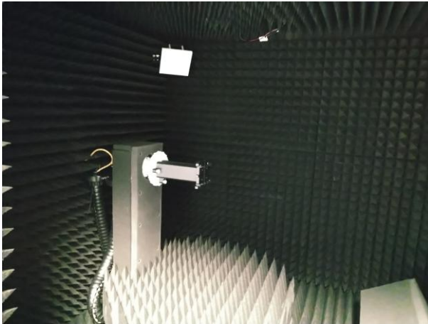
コンパクトアンテナテストレンジ内部
